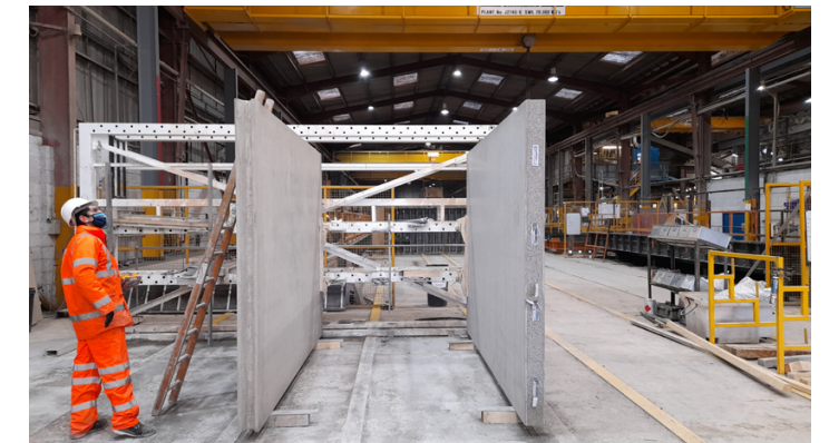
Precast wall slabs
